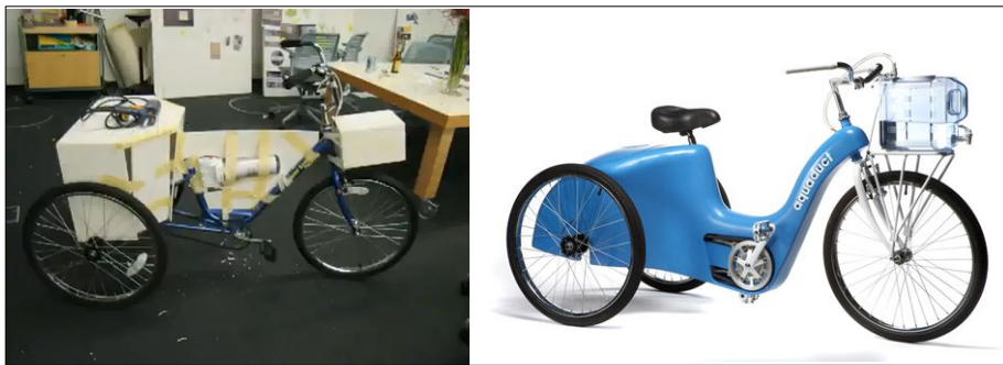
<그림 2> IDEO사의 제품, 아쿠아덕트(Aquaduct)의 프로토타입과(좌) 완성품(우)
