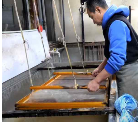
【그림 3】 좌 : 외발뜨기 (문경전통한지) 우 : 쌍발뜨기 (미조다 와시공방)
