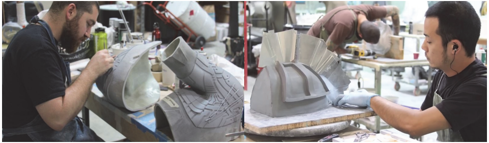
<그림 19> 영화 '로보캅'의 3D프린터 출력물과 몰드 작업 (출처: http://cgeverything.co.uk/2014/04/22/making-of-the-robocop-suit-legacy-effects/ , 2017.03.08. 검색)
