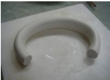
7. 사각형 석고판을 이용해 손으로 직접 깎아가며 주전자 손잡이 원형을 제작한다.
