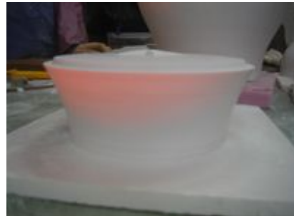
14. 13번에 칼리비누를 칠한 후 석고를 부어 제형칼을 이용해 합 의 아랫부분에 해당하는 원형을 제작한다.
