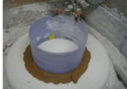
6. 5번을 다시 제형물레에 고정시키고 불이 담길 부분에 석고를 부은 후 제형칼을 이용해 불을 제작한다.
