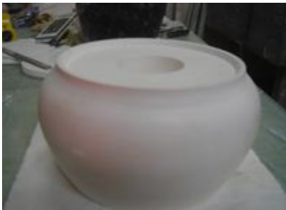
13. 제형물레에서 제형칼을 이용해 합 의 윗부분에 해당하는 원형을 제작한다. 그리고 14번 제작과정을 위해 윗부분과 아랫부분이 서로 떨어지지 않도록 바닥면에 십자모양의 홈을 내준다.
