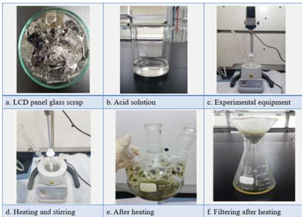
그림 9. 폐 디스플레이 패널 유리 스크랩으로부터 인듐 추출 실험 과정
