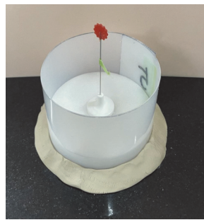
【그림 15】 뚜껑의 몰드 제작 과정
