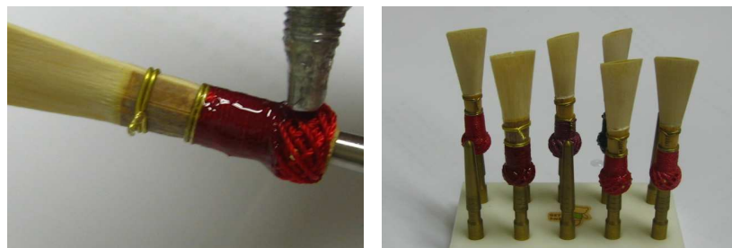
[그림72] 좌: PVC 본드 칠하는 모습 우: 건조대에서 말리는 모습
