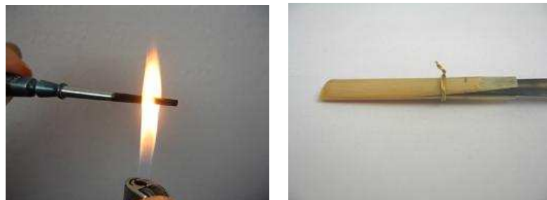
[그림36] 좌: 맨들을 데우는 모습 우: 케인 속에 맨들을 넣은 모습
