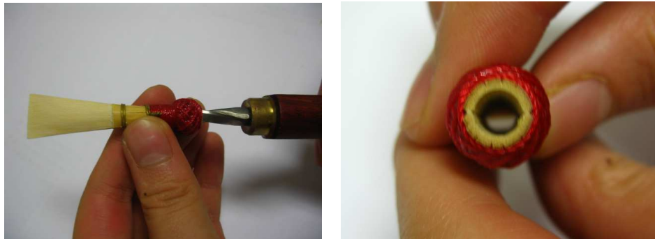
[그림 76] 리머로 구멍 만드는 모습
