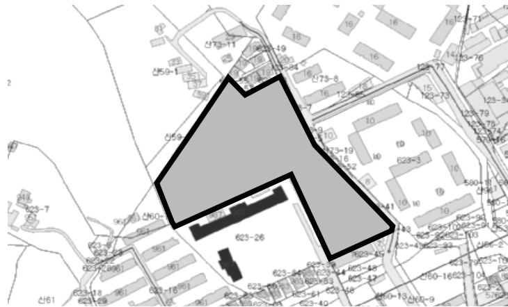
〈그림 12〉 지번주소의 문제점2 : 한 건물이 여러 지번에 걸쳐있는 경우 (인천광역시 계양구 효성동 산 59-5 외 6필지) 출처: 행정자치부, 2007, 묻지않고 찾아가는, 자신있는 발걸음.
