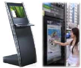
아웃도어 미디어키오스크 길거리 또는 지하철/철도 역사 내에 설치된 옥외 컴퓨터로 특정 정보 검색 등의 목적으로 이용할 수 있음
