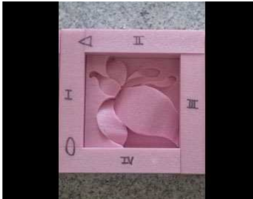
<사진5> 원형을 이용한 간틀제작-1
