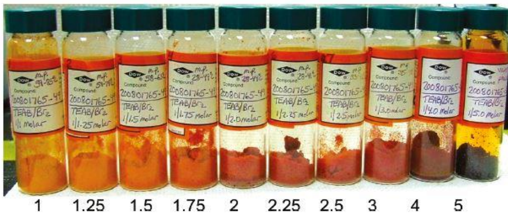
Figure 6. Tetraethylammonium bromide에 Br 2 기체를 당량별로 반응시킨 후의 모습 31
