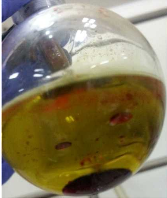
Figure 11. (c) 교반 후 두 개의 층으로 분리됨; 수용액 층(위)과 유기층(아래)
